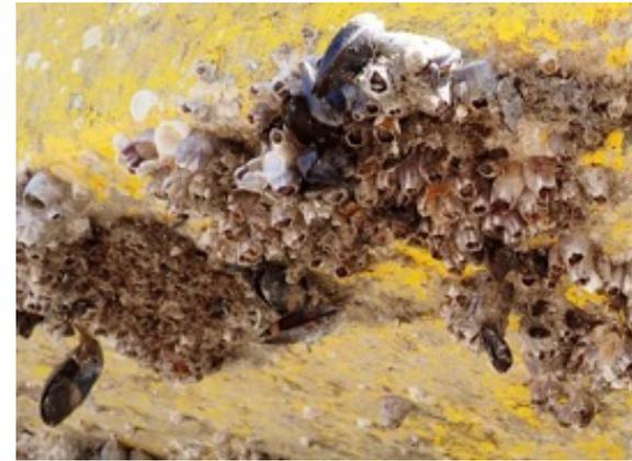
フジツボなどの付着生物が船底などの人工物に付着すると、船舶の燃費効率の低下や温室効果ガスの排出増加を引き起こします。生物が付着に至るメカニズムを解明し、付着防除に寄与する研究を推進しています。
