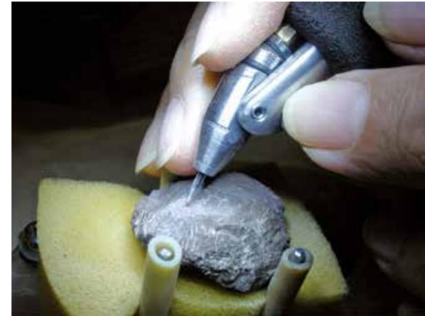
写真2 世界最小の削岩機「和田式エアスクライブ」
