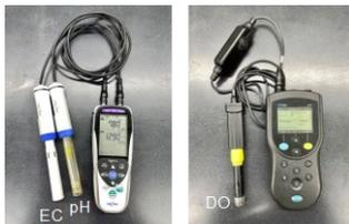
a) EC 計測      b) DO 計測
