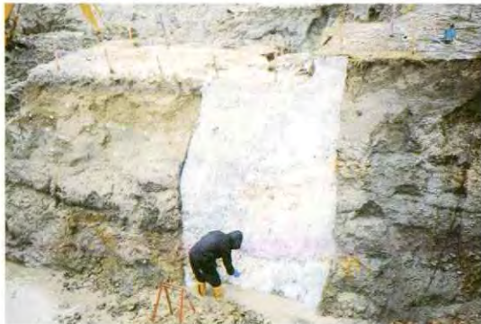
3: きれいにした壁面に、アセトンで薄めた樹脂を吹き付ける。表層を固め、薄い膜をつくる。
