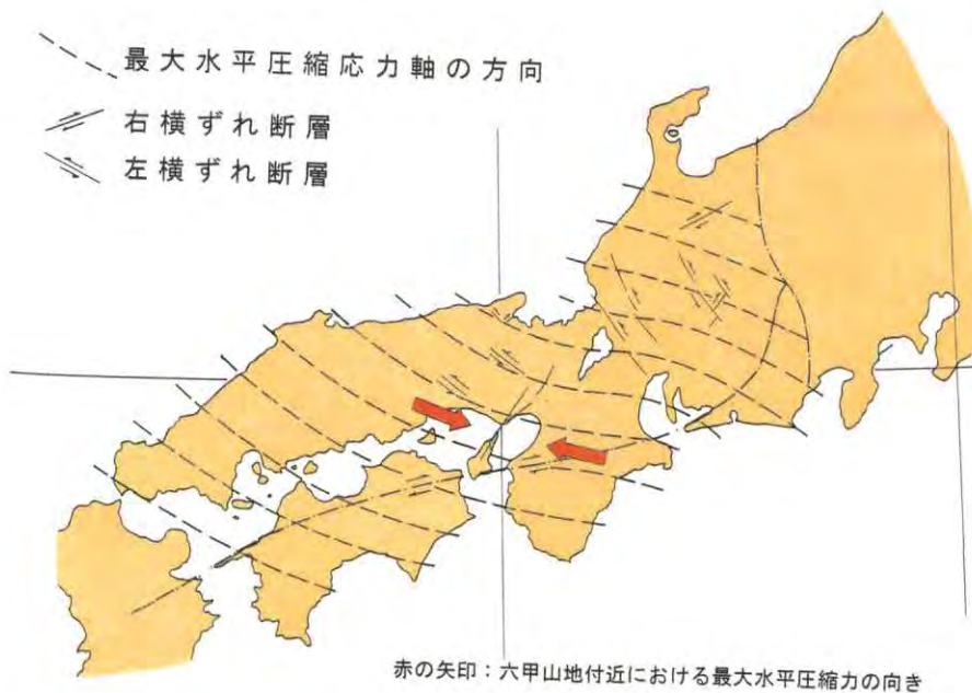
図5-6 活断層のずれ方から求めた近畿地方周辺の応力分布（藤田、1968による）
